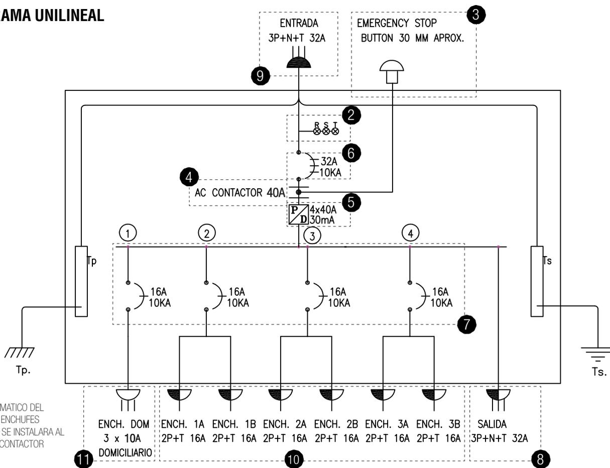
NOTA: EL AUTOMATICO DEL CIRCUITO 1 DE ENCHUFES DOMICILIARIOS SE INSTALARA AL COSTADO DEL CONTACTOR
